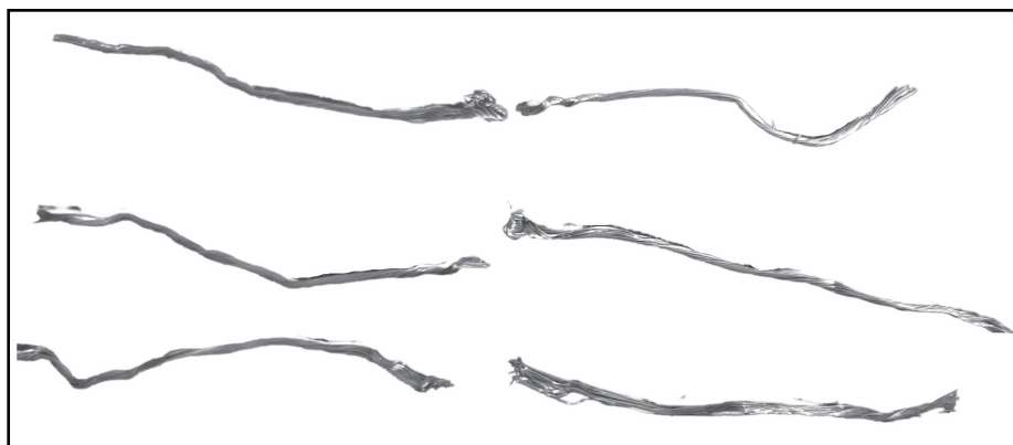
Figura 5 – Emendas de caixa após teste de tração
